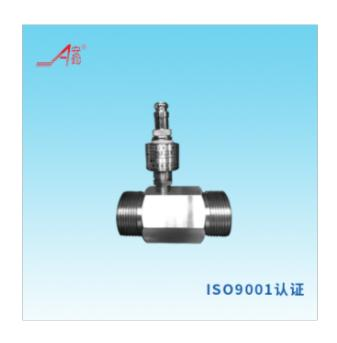
无可动机械零件,因而气体涡轮流量计可靠性高,维护量小。外表参数能长期安稳。气体涡轮流量计采用压电应力式传感器,可靠性高,可在-20℃<sup>+</sup>+250℃的作业温度范围内作业。有模仿标准信号,也有数字脉冲信号输出,容易与计算机等数字系统配套运用,是一种比较先进、抱负的流量外表。气体涡轮流量计输出的脉冲频率信号不受流体物性和组分改变的影响,即外表系数在一定雷诺数范围内只与旋涡产生体及管道的形状尺寸等有关。可是作为流量计在物料平衡及动力计量中需检测质量流量,这时流量计的输出信号应同时监测体积流量和流体密度,流体物性和组分对流量计量仍是有直接影响的。气体涡轮流量计便是依据卡门旋涡原理进行关闭管道流体流量丈量的新式流量计。因其具有良好的介质适应能力,无需温度压力补偿即可直接丈量蒸汽、空气、气体、水、液体的工况体积流量,装备温度、压力传感器可丈量标况体积流量和质量流量,是节流式流量计的抱负替代产品。
