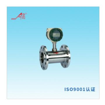
1、气体涡轮流量计宜缓慢地加压和启动,快速打开阀门的冲击负载通常会损坏叶轮。2、如果需要在涡轮流量计附近的管线上做焊接工作,则必须将涡轮流量计拆下来进行。否则,会阴管道温度过高而导致流量计的长期破坏。3、安装气体涡轮流量计时,注意使气体流动方向与表壳上箭头所指的方向一致,安装失误会导致对涡轮流量计的破坏。4、管道必须没有震动,管道内的气流不能有大的脉动和杂质,没有灰尘和液体,进入管路的外来物质会严重地损坏涡轮流量计,当预计气体流中可能存在损坏流量计的外来物质时,建议在涡轮流量计上游管道安装过滤器。气体涡轮流量计在设计上越来越新颖,灵巧,以其独到而别具实用性的设计特色触摸时尚。青岛气体涡轮流量计规格
